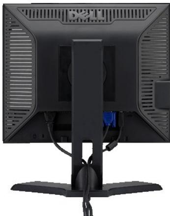
モニターおよびコンピュータに必要なケーブルすべてを取り付けた後、[モニターを接続する](#)を参照) 上記のとおり、ケーブル管理スロットを使って、すべてのケーブルを整理します。
